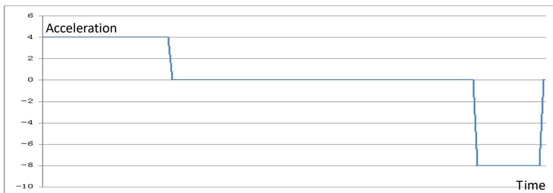
图 7.7 T 曲线点到点运动加速度曲线
