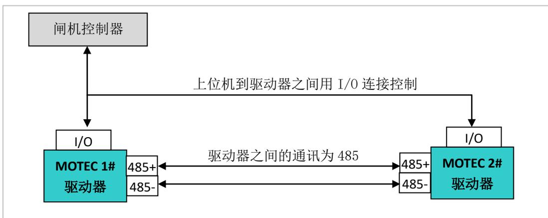
图 8.8 I/O 口控制+ RS485 通讯互联
