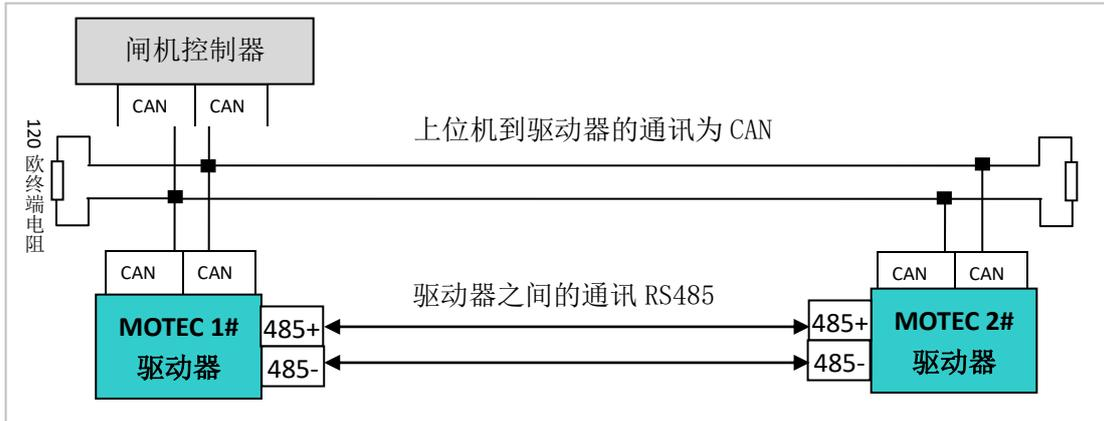
图 8.5 CAN 上位机+ RS485 通讯互联
