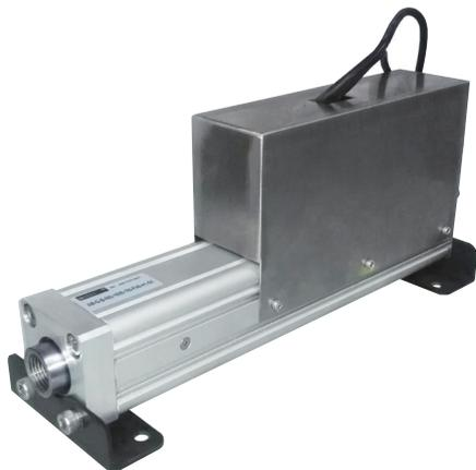
电动缸是伺服电机与丝杠集合而成的一体化模块产品，将伺服电机的旋转运动转换成直线运动，是实现高精度直线运动系列的全新产品。电动缸具有传动效率高、定位精度高、维护方便、静音运行、可靠性和安全性高、使用寿命长等优点。电动缸广泛应用于机器人手臂、实验设备、焊接设备、航空航天测试平台、多自由度模拟器、阀门控制、数控机床、动感影院等行业领域。
