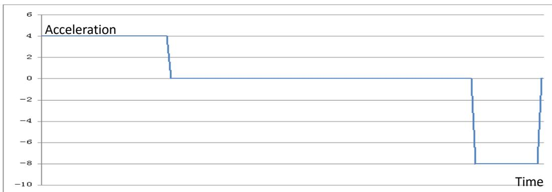
图 7.3 T 曲线点到点运动加速度曲线
