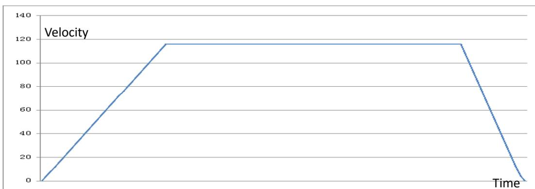
图 7.2 T 曲线点到点运动速度曲线
